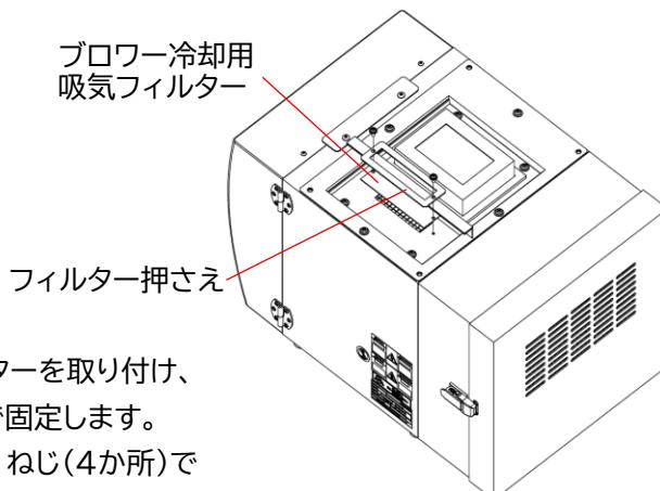
3. 新しいブロワー冷却用吸気フィルターを取り付け、
