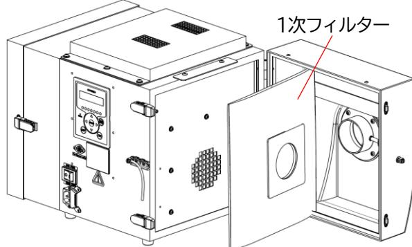
5. 新しい1次フィルターを取り付け、2次フィルターを元通りに取り付けます。
