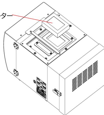
3. 新しいブロワー冷却用排気フィルターを取り付けます。
