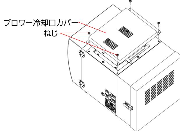
2. ねじ(2か所)を緩め、フィルター押さえ、ブロワー冷却用吸気フィルターを取り外します。
